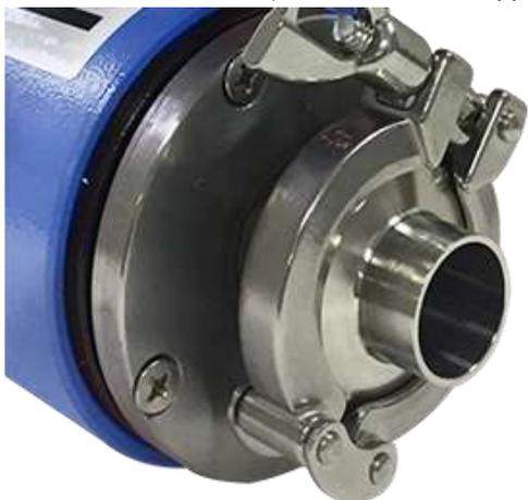
Кламповое соединение имеет довольно простую конструкцию - состоит из хомута и двух полуколец, соединенных штифтом, двух штуцеров из специальной нержавеющей стали и уплотнения. Несмотря на всю простоту конструкции, с его помощью можно за несколько минут подключить расходомер к трубопроводу или демонтировать.
