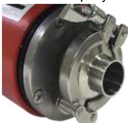
Кламповое соединение имеет довольно простую конструкцию - состоит из хомута и двух полуколец, соединенных штифтом, двух штуцеров из специальной нержавеющей стали и уплотнения. Несмотря на всю простоту конструкции, с его помощью можно за несколько минут подключить расходомер к трубопроводу или демонтировать. Такое соединение характеризуется высокой герметичностью и надежностью.
